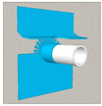
STEP 2 INSTALL A MEMBRANE ON THE WALL TO COVER THE LOWER HALF OF THE PIPE.
