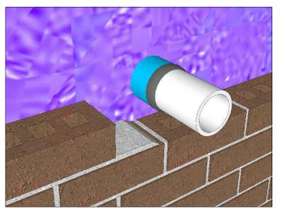
STEP 4 SPRAY WALLTITE<sup>®</sup> BEFORE LAYING BRICKS.
